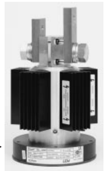
▶ 4: Triaxialbreitbandshunt von LEM Instruments mit einer Bandbreite von 2 MHz und einem extrem kleinen Winkelfehler
