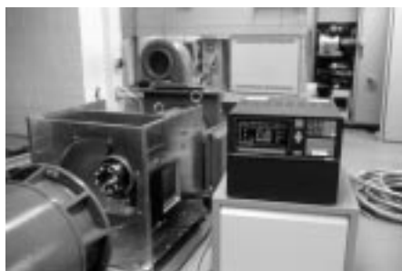
1: Forschungs- und Entwicklungsprüfstand für Elektromotoren, Umrichter und Getriebe am Steinbeis-Transferzentrum Geislingen
